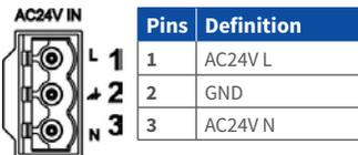
Schließen Sie den DC12V- oder AC24V-Netzadapter an den Netzanschluss der Kamera und eine Steckdose an. Bitte berücksichtigen Sie bei der Nutzung eines AC24V-Adapters das nachstehende Diagramm samt Pindefinitionen.
