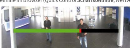
Drehen Sie das Objektiv mit der Hand vorsichtig hin und her, bis der rote Bereich der Scharfstellhilfe möglichst vollständig verschwunden ist. **Außer D16-Panorama/180°:** Schalten Sie auf den anderen Bildsensor um (Quick Control Kamera-Auswahl) und wiederholen Sie den Vorgang, falls erforderlich.
